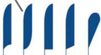
esempi di soluzioni ottenibili in base al tensionamento dell'ultimo segmento della bandiera
